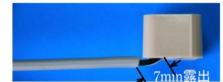
欠陥の例：絶縁被覆が 5mm 以上露出
