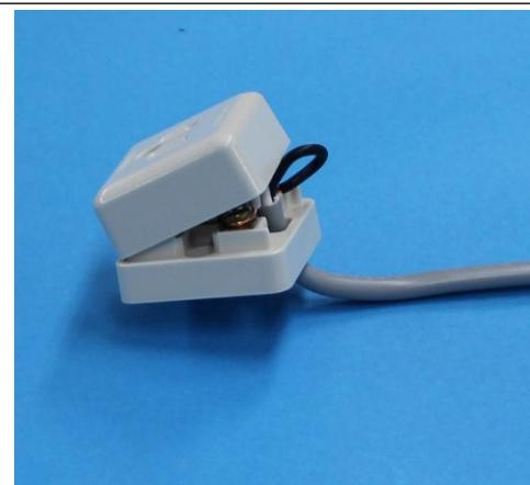
欠陥の例：絶縁被覆がはみ出ているため、カバーが閉まらない
